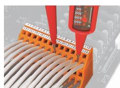
Tester par contact direct sur la surface de contact au-dessus du conducteur
