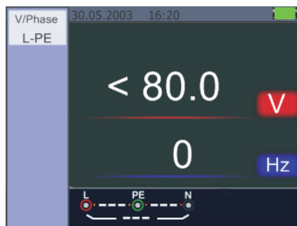
Figure 20 Écran lors de la mesure de la tension et de la fréquence
