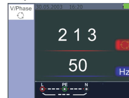
Figure 24 Séquence de phase: lorsqu'elle est connectée dans le sens inverse des aiguilles d'une montre
