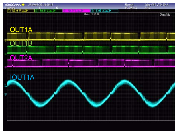
Figure 19. 1/16 STEP 駆動波形 ( CLK : 9600Hz )
