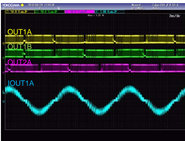
Figure 18. 1/8 STEP 駆動波形 ( CLK : 4800Hz )
