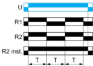
**Fonction Dit : clignoteur symétrique (démarrage au travail) avec signal de contrôle (pause/totalisateur)**
