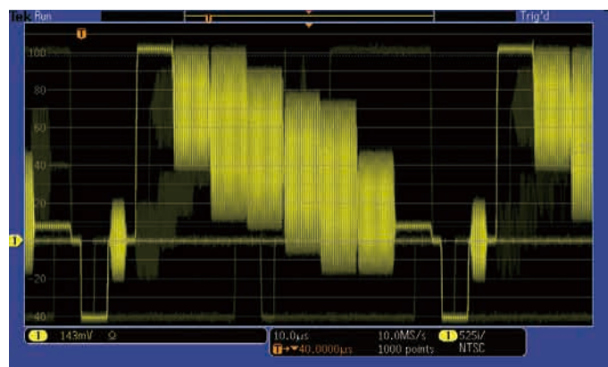
NTSCビデオ信号の観測例。DPOの持つ輝度階調表示機能により、時間、振幅および頻度が観測できる
