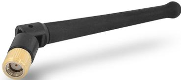
Ixxat 外部スタブアンテナは、無線通信システムの性能を向上させるために使用されます。これは、Ixxat CANblue II および Ixxat ネジ込み可能アンテナベースとの互換性を目的に特別に設計された高品質のアクセサリです。無線接続を安定させることによって、信頼性が高く効率的なシステム動作を保証します。これには、より安定した無線データ伝達を実現する 1/2 波長同軸ダイポールが備わっています。90 度回転トグルにより最適な位置決めが可能になり、最適な信号カバレッジを確保します。
