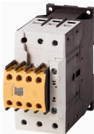
**Sicherheitsschütz, 380 V 400 V: 18.5 kW, 2 S, 2 Ö, 230 V 50 Hz, 240 V 60 Hz, Wechselstrombetätigung, Schraubklemmen, Mit Spiegelkontakt.**
