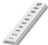
Repérage ZB, plat, Rubans, blanc, repéré, impression longitudinale: numérotation continue 1 ... 10, 11 ... 20, etc. jusqu'à 91 ... 100, type de montage: encliquetage dans la rainure de repérage plate, pour bloc de jonction au pas de : 3,5 mm, surface utile: 5,15 x 3,5 mm
