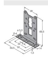
**MW-Q14/Q20 6945006** Montagewinkel für Quaderbauform Q14 oder Q20; Werkstoff VA 1.4301
