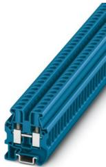
微型直通式接线端子，标称工作电压: 500 V，额定电流: 32 A，连接量: 2，接线方式: 螺钉连接，第一层，额定接线容量: 4 mm<sup>2</sup>，横截面: 0.2 mm<sup>2</sup> - 6 mm<sup>2</sup>，安装方式: NS 15，颜色: 蓝色
