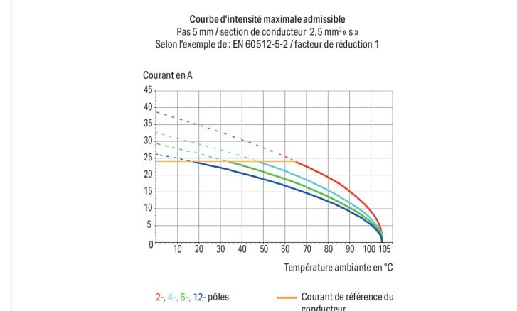
Borne pour circuits imprimés série 737 avec introduction du conducteur vers la platine de 45 °
