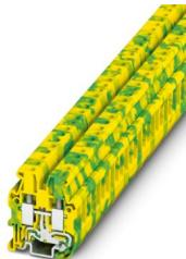
微型接地端子，连接量: 2，位数: 1，接线方式: 螺钉连接，第一层，额定接线容量: 4 mm<sup>2</sup>，横截面: 0.2 mm<sup>2</sup> - 6 mm<sup>2</sup>，安装方式: NS 15，颜色: 黄绿相间
