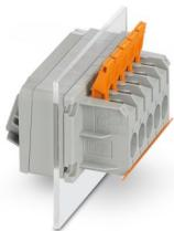
嵌板穿通接线柱块，接线方式: 推插锁紧式 (Push-lock) 连接，直插式弹簧连接，位数: 4，负载电流: 41 A，横截面: 2.5 mm<sup>2</sup> - 16 mm<sup>2</sup>，导线连接方向与拔插方向的夹角: 0°，宽度: 64.4 mm，颜色: 灰色
