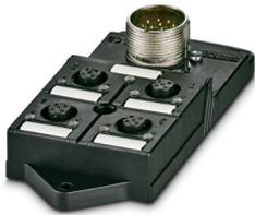
分线盒，应用：标准，接线方式: M12孔式 塑料，插槽数目: 4，位数: 5，编码: A，插槽类型: 双通道，状态显示: 否，通用; 主电缆连接: M23针式插头连接 90°，屏蔽: 无
