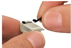
Détrompage d'un connecteur mâle - encliquer le (les) détrompeur(s)
