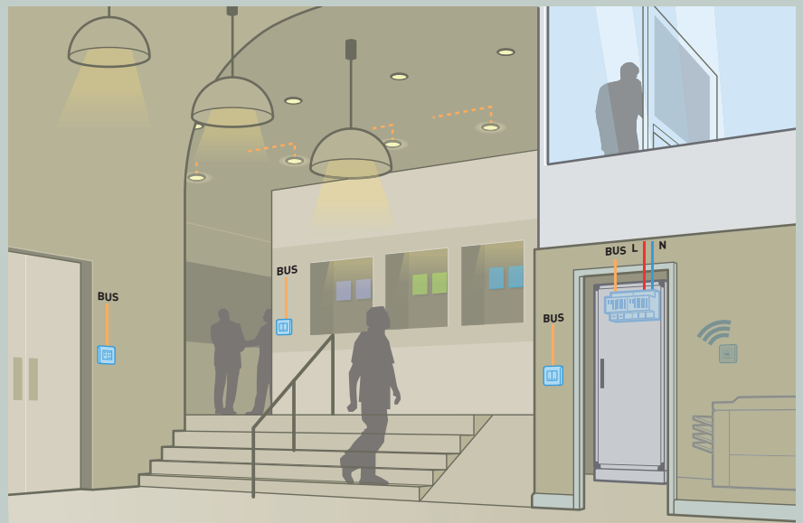
Das 2-polige Buskabel verbindet alle Komponenten: REG, Touch Screen, Einzelschalter, IR-Empfänger
