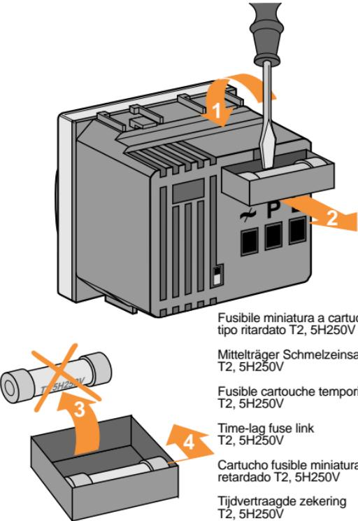
ATTENZIONE : per sostituire i fusibili danneggiati togliere sempre la tensione di rete (disinserire l'interruttore generale).
