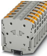
大电流接线端子，带测试插座，标称工作电压: 1000 V，额定电流: 232 A，连接量: 2，位数: 1，接线方式: PowerTurn连接，横截面: 25 mm<sup>2</sup> - 95 mm<sup>2</sup>，安装方式: NS 35/15，颜色: 灰色
