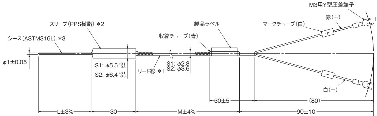
\*1. リード線(補償導線)(Y端子部分除く)
