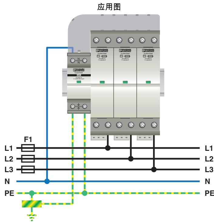
3+1回路结构，用于TN-S-TT系统，带有N/PE放电间隙和类型1雷电流保护装置 (FLT-SEC-H)
