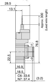
M plug connector (M): SY3120- $\square$ M $\square$ - $^{C4, N3}_{C6, N7}(-F^1_2)$ -Q
