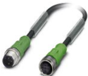
センサ/アクチュエータケーブル, 3-極, PUR ハロゲンフリー, 黒-灰RAL 7021, プラグ ストレート M12, Aコーディング, 上 ソケット ストレート M12, Aコーディング, ピン2と4をブリッジ, ケーブル長: 0.6 m
