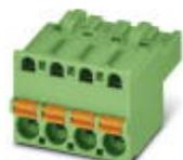
Connecteur mâle pour C.I., intensité nominale: 12 A, nombre de pôles: 4, pas: 5,08 mm, type de raccordement: Raccordement à ressort Push-in, coloris: vert, surface des contacts: étain
