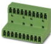
Embase de circuit imprimé, intensité nominale: 8 A, nombre de pôles: 5, pas: 3,81 mm, coloris: vert, surface des contacts: étain, montage: Soudage à la vague, En cas de combinaison avec des éléments enfichables MCV, utiliser respectivement un connecteur mâle MCVW et un connecteur mâle MCVR.
