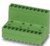
Embase de circuit imprimé, intensité nominale: 8 A, nombre de pôles: 5, pas: 3,81 mm, coloris: vert, surface des contacts: étain, montage: Soudage à la vague, En cas de combinaison avec des éléments enfichables MCV, utiliser respectivement un connecteur mâle MCVW et un connecteur mâle MCVR.
