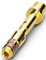
压接插针，孔式插头，车削，单个插针，触点直径: 1 mm，压接范围: 0.25 mm<sup>2</sup> ... 1 mm<sup>2</sup>，备选
