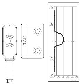
Distância de ligação protegida  $S_{Ao}$  6 mm Atuador "Standard", superfície do sensor ativa frontal
