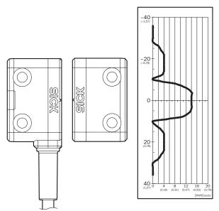
Distância de ligação protegida  $S_{Ao}$  10 mm. Observar áreas marginais na aproximação paralela: quando o atuador se move lateralmente à superfície do sensor, deve ser mantida uma distância mínima de 6 mm. Isso impede um disparo precoce causado pelas áreas de encosto laterais.
