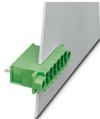
穿墙式插座，额定横截面: 4 mm<sup>2</sup>，颜色: 绿色，额定电流: 15 A，额定电压(III/2): 400 V，触点表面: Sn，触点类型: 针式插头，电位数: 5，行数: 1，位数: 5，连接量: 5，产品系列: DFK-PC 4/..-G -LOE，针距: 7.62 mm，接线方式: 焊接，安装: 焊接，针脚排列: 直线排列，焊针[P]: 5.87 mm，每个电势的焊针数量: 2，插拔系统: COMBICON PC 4，针式连接器样式对齐: 标准，互锁: 不带，安装方式: 不带，包装类型: 纸箱包装
