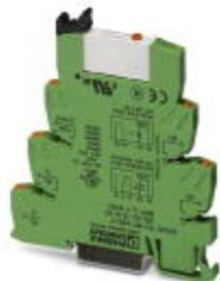
PLC-INTERFACE, composé d'un module de base PLC-BPT.../21 à raccordement Push-in et d'un relais miniature enfichable à contact de puissance et actionnement manuel, 1 contact inverseur, tension d'entrée 12 V DC
