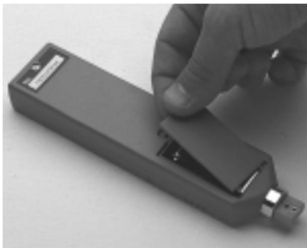
sostituire la batteria esaurita con altra carica.
