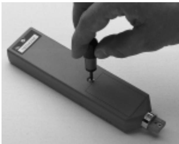
Per sostituire la batteria svitare la vite con testa a croce dello sportellino vano batteria
