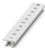
Nastro Zack, Striscia, bianco, siglato, siglabile con: CMS-P1-PLOTTER, siglatura longitudinale: numeri progressivi 1 ...10, 11 ...20 ecc. fino a 491 ...500, tipo di montaggio: inserimento a scatto in scanalatura alta portacartellini, per morsetti con spessore: 6,2 mm, dimensioni campo di siglatura: 6,15 x 10,5 mm, Numero dei cartellini singoli: 10
