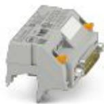
Adattatore V8 per 8 x PLC-INTERFACE (6,2 mm), controllo: Cablaggio di sistema PLC delle schede d'ingresso, collegamento 1: Connessione a vite 1x, collegamento 2: Connettore maschio D-SUB 1x 15-poli, collegamento 3: Attacco connettore (Può essere agganciato a scatto su 8 morsetti PLC-INTERFACE), numero di canali: 8, logica di comando: commutazione positiva
