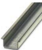
Guida di supporto, non perforata, Profilo standard, larghezza: 35 mm, altezza: 15 mm, simile a norma EN 60715, materiale: Acciaio, zincato, passivato a strato spesso, lunghezza: 2000 mm, colore: color argento
