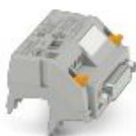
Adattatore V8 per 8 x PLC-INTERFACE (6,2 mm), controllo: Cablaggio di sistema PLC delle schede d'ingresso, collegamento 1: Connessione a vite 1x, collegamento 2: Connettore femmina D-SUB 1x 15-poli, collegamento 3: Attacco connettore (Può essere agganciato a scatto su 8 morsetti PLC-INTERFACE), numero di canali: 8, logica di comando: commutazione positiva
