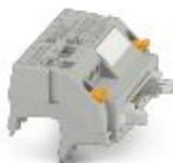
Adattatore V8 per 8 x PLC-INTERFACE (6,2 mm), controllore: Cablaggio di sistema PLC delle schede d'ingresso, collegamento 1: Connessione a vite 1x, collegamento 2: Connettore maschio IDC/FLK 1x 14-poli, collegamento 3: Attacco connettore (Può essere agganciato a scatto su 8 morsetti PLC-INTERFACE), numero di canali: 8, logica di comando: commutazione positiva
