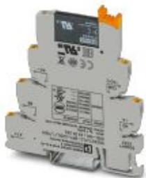
PLC-INTERFACE per funzioni di input, composta da morsetto base PLC-BPT.../SEN con connessione Push-in e relè a stato solido in miniatura a innesto, per il montaggio su guida di montaggio NS 35/7,5, 1 contatto aperto a riposo, ingresso: 24 V DC, uscita: 3-48 V DC/100 mA
