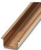
Guida di supporto, non perforata, Profilo standard, larghezza: 35 mm, altezza: 15 mm, simile a norma EN 60715, materiale: rame, non rivestito, lunghezza: 2000 mm, colore: rame
