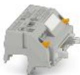
Adattatore V8 per 8 x PLC-INTERFACE (6,2 mm), controllore: Cablaggio di sistema PLC delle schede d'ingresso, collegamento 1: Connessione a vite 1x, collegamento 2: Connettore maschio IDC/FLK 1x 14-poli, collegamento 3: Attacco connettore (Può essere agganciato a scatto su 8 morsetti PLC-INTERFACE), numero di canali: 8, logica di comando: commutazione negativa
