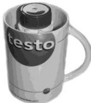
2. Wasser in einem Gefäß (z. B. einer Tasse) auf ca. 50 °C erhitzen. Geschlossene Referenzölfflasche für ca. 10 min in das Wasserbad stellen (Wasserhöhe maximal bis Unterkante Verschlusskappe). Anschließend die geschlossene Referenzölfflasche kurz schütteln, zur besseren Wärmeverteilung in der Flasche.
