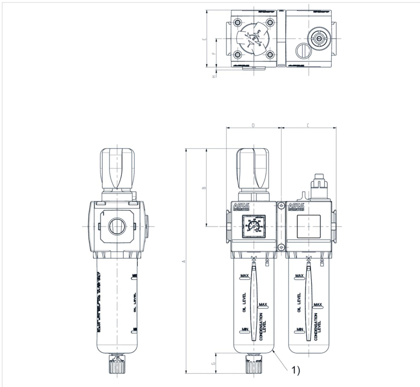
1) Pour retirer le bac, observer une distance de 80 mm au bord inférieur de l'évacuation du bac.
