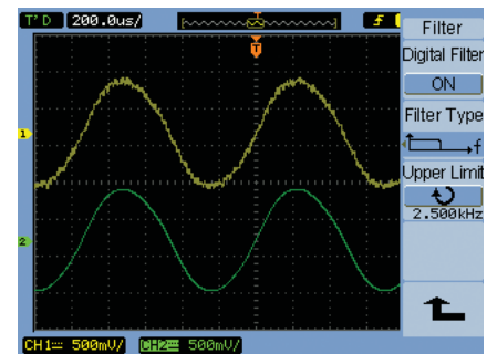
Abbildung 9. Ch 1 (gelb) zeigt ein ungefiltertes Eingangssignal und Ch 2 (grün) das gleiche Eingangssignal nach Tiefpassfilterung.
