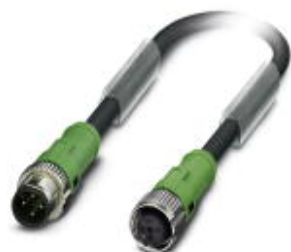
センサ/アクチュエータケーブル, 4-極, PUR, 黒-灰RAL 7021, プラグ ストレート M12 SPEEDCON, Aコーディング, 上 ソケット ストレート M12 SPEEDCON, Aコーディング, ケーブル長: 10 m
