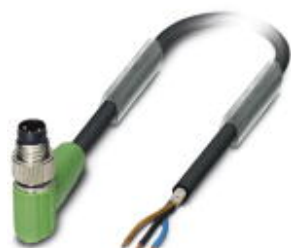
センサ/アクチュエータケーブル, 3-極, PUR ハロゲンフリー, 黒-灰RAL 7021, シールド対応, プラグ アングル M8, 上 片側フリー, ケーブル長: 3 m
