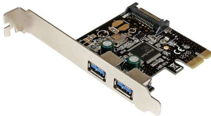
La scheda PCI Express USB 3.0 a 2 porte PEXUSB3S23 consente di aggiungere 2 porte USB 3.0 a qualsiasi computer dotato di PCI Express. La scheda USB richiede l'alimentazione SATA per il funzionamento e fornisce 900 mA di alimentazione per porta a dispositivi USB 3.0 alimentati tramite bus (500mA per USB 2.0) tramite il connettore di alimentazione SATA per computer.
