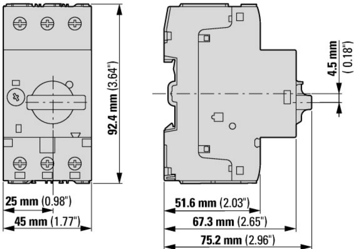
Disjoncteur de protection moteur avec contacts auxiliaires de position
