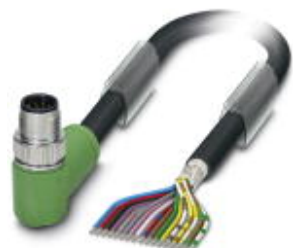
センサ/アクチュエータケーブル, 17-極, PUR/PVC, 黒RAL 9005, シールド対応, プラグ アングル M12 SPEEDCON, Aコーディング, 上 片側フリー, ケーブル長: 10 m
