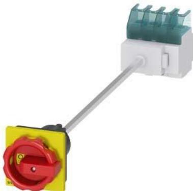
SENTRON, Lasttrennschalter 3LD, Not-Aus-Schalter, 4- polig, Iu: 32 A, Betriebsleistung / bei AC-23 A bei 400V: 11,5 kW, Bodenbefestigung mit Türkupplung, Drehantrieb, rot/gelb, 4-Loch Befestigung der Handhabe
