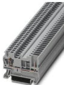
Durchgangsklemme, Nennspannung: 500 V, Nennstrom: 24 A, Anschlussart: Zugfeder- / Steckanschluss, Anzahl der Anschlüsse: 2, Querschnitt: 0,08 mm<sup>2</sup> - 4 mm<sup>2</sup>, AWG: 28 - 12, Breite: 5,2 mm, Farbe: grau, Montageart: NS 35/7,5, NS 35/15
