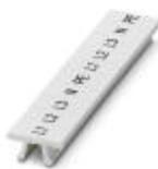
Zackband, Streifen, weiß, beschriftet, längs: L1, L2, L3, N, PE, L1, L2, L3, N, PE, Montageart: verrasten in hoher Schildchennut, für Klemmenbreite: 5,2 mm, Schriftfeldgröße: 5,15 x 10,5 mm
