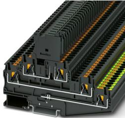
保险丝接线端子，保险丝类型: 玻璃 / 陶瓷 / ...，保险丝类型: G / 5 x 20，标称工作电压: 24 V，额定电流: 6.3 A，接线方式: 直插式连接，额定接线容量: 4 mm<sup>2</sup>，接线容量: 0.2 mm<sup>2</sup>- 6 mm<sup>2</sup>，接线方式: 直插式连接，接线容量: 0.2 mm<sup>2</sup>- 6 mm<sup>2</sup>，安装方式: NS 35/7,5，NS 35/15，颜色: 黑色
