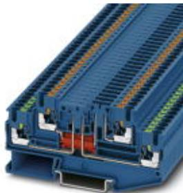
Trennklemme, mit Trennstecker, Anschlussart: Push-in-Anschluss, Querschnitt: 0,14 mm<sup>2</sup> - 4 mm<sup>2</sup>, AWG: 26 - 12, Nennstrom: 16 A, Nennspannung: 400 V, Länge: 92,4 mm, Breite: 5,2 mm, Farbe: blau, Montage: NS 35/7,5, NS 35/15
