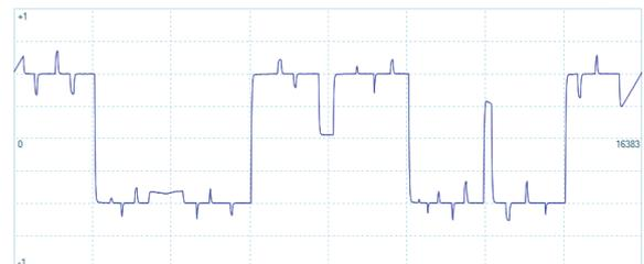
Ebenfalls enthalten ist ein vollständig programmierbarer Generator für anwenderdefinierte Wellenformen mit einem Puffer für bis zu 8000 Abtastungen.
