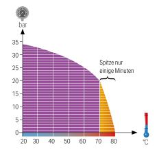
Betriebsdruck bis 20 bar bei 70°C
