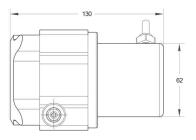
Push-Pull Cable Output +V : Brown 0V : White GND : Shield Ch A : Yellow Ch B : Green Ch Z : Gray
