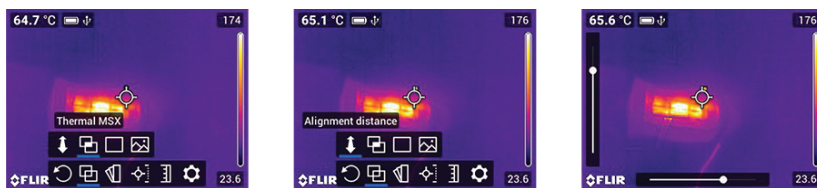
Figure 7.5 Sélectionnez le mode MSX thermique, puis l'option Distance d'alignement. Utilisez les curseurs (à gauche et en bas de l'écran) pour aligner l'image de la caméra numérique sur l'image thermique. Utilisez les boutons gauche/droite et haut/bas pour effectuer les réglages.
