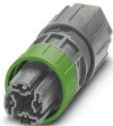
Steckverbinder, QUICKON-Anschluss, Polzahl: 4, 1 mm<sup>2</sup> ... 2,5 mm<sup>2</sup>, 690 V, 20 A, grau, Kabeldurchmesserbereich: 9 mm ... 14 mm
