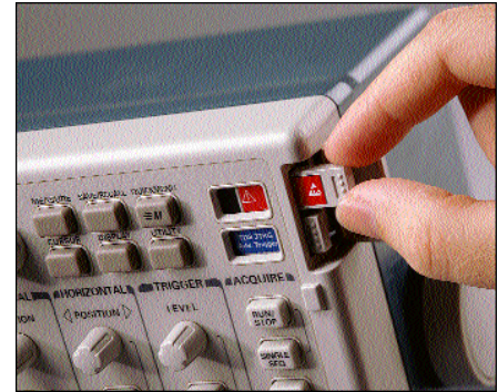
Anwendungsmodul wird eingebaut.
