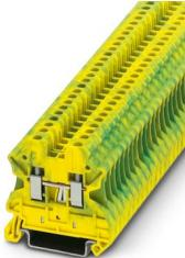
接地端子，连接量: 2，接线方式: 螺钉连接，额定接线容量: 2.5 mm<sup>2</sup>，横截面: 0.14 mm<sup>2</sup> - 4 mm<sup>2</sup>，安装方式: NS 35/7,5，NS 35/15，颜色: 黄绿相间
