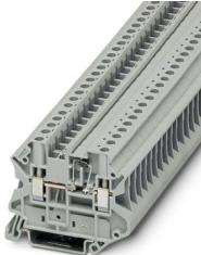
元件端子，集成1N4007二极管，额定电流: 0.5 A，连接量: 2，接线方式: 螺钉连接，额定接线容量: 4 mm<sup>2</sup>，横截面: 0.14 mm<sup>2</sup> - 6 mm<sup>2</sup>，安装方式: NS 35/7,5，NS 35/15，颜色: 灰色
